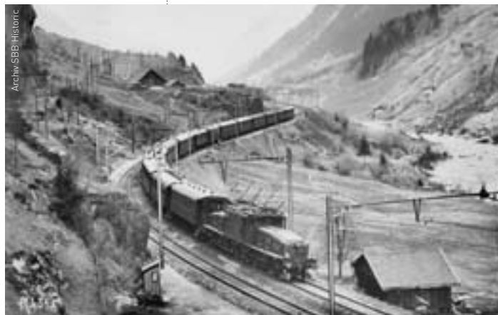
(links) Der Entscheid der SBB 1916, die Gotthardlinie zu elektrifizieren löste viele Aufträge aus. Druckröhre des Kraftwerks Amsteg um 1920. (rechts) Werkfoto der MFO mit Elektrolokomotive Ce 6/8 II «Krokodil», die einen Schnellzug die Nordrampe hinaufzieht, um 1920.
